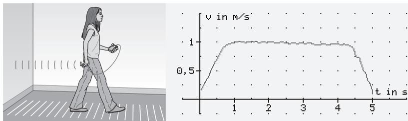
wieder stehen. Während des Vorgangs trägt sie ein nach hinten gerichtetes Sonarmeter mit sich. Ein daran angeschlossener grafikfähiger Taschenrechner liefert das abgebildete  $t$ - $v$ -Diagramm.
