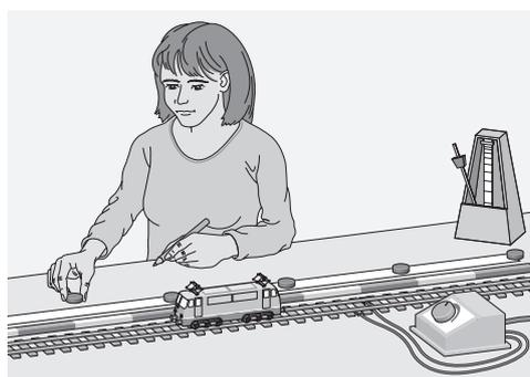
**V2** Wiederhole die Fahrt der elektrischen Eisenbahn. Lass sie diesmal mit Hilfe eines Fadens einen Tachometer antreiben, der die Geschwindigkeit der Eisenbahn misst. Die Anzeige des Tachometers wird z. B. mit einem grafikfähigen Taschenrechner aufgezeichnet. Man erkennt, dass die Geschwindigkeit in etwa gleich bleibt.
