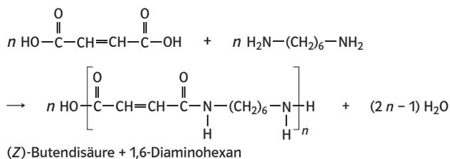
c) Beispiellösung: Formelausschnitt eines möglichen Duromer-Moleküls
