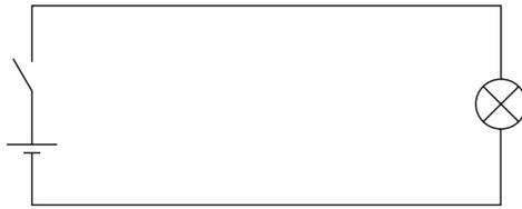
**A12** ☹ Die Lampe kann defekt sein oder ist nicht richtig in die Fassung geschraubt. Es kann ein Defekt im Schalter vorliegen und es kann auch eine der Leitungen unterbrochen (z. B. durchgebrannt) sein.
