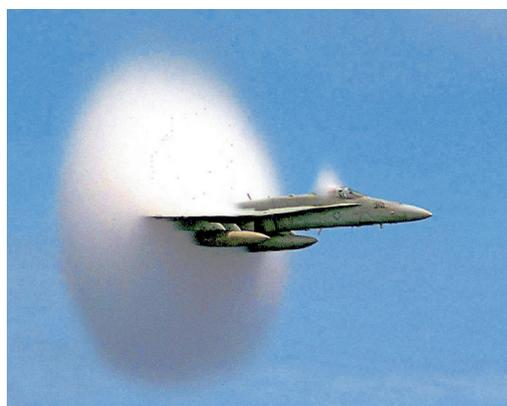
**Abb. 14.28** Diese F/A 18 durchbricht gerade die Schallmauer. Hinter der Stoßfront sinkt der Luftdruck stark ab. Dadurch kondensiert der Wasserdampf zu einem netten Wölkchen. Man nennt das Wolkenscheibeneffekt.
