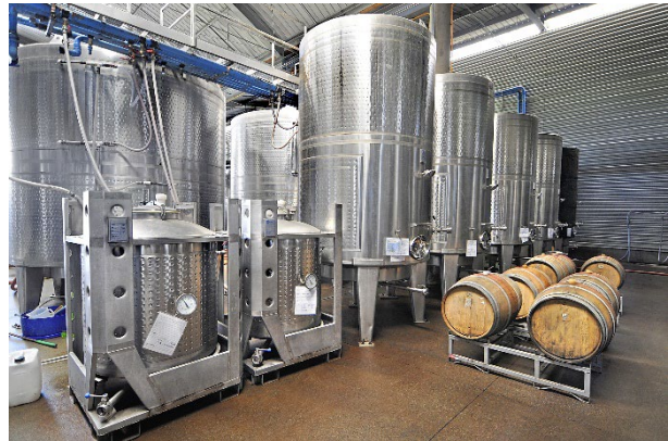
B1 Gärtanks verhindern den Zutritt von Sauerstoff
