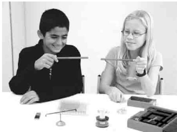
**V3** Hänge einen Stabmagneten wie in der Abbildung frei drehbar auf. Notiere deine Beobachtung. Stoße den Magneten an und beobachte erneut. Der Magnet kommt immer in derselben Ausrichtung zur Ruhe.
