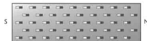
**A1** Überstreiche einen Eisennagel mehrmals mit einem Stabmagneten von einem Ende zum anderen Ende. Achte unbedingt darauf, dass du immer in dieselbe Richtung streichst und dass du immer denselben Pol des Magneten verwendest. Beschreibe, was bei diesem Vorgang passiert.
